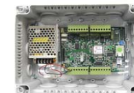
Electrónica BioMax2 en caja eléctrica
